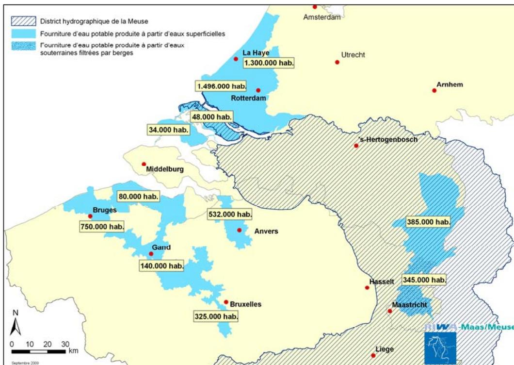
Figure 6 – Zones de distribution d'eau potable produite à partir des eaux de la Meuse
